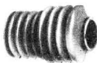
M.R.1192 fuelle cremallera dirección R-4/5 (hasta '77) r.o. 7702047822
