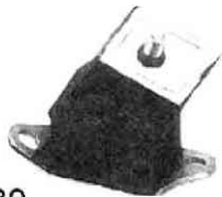
M.R.1189 soporte motor izquierdo R-9/11 GTX-TXE y SUPER 5 GTX-90, r.o. 7700755531
