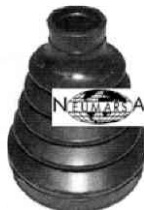
M.R.0982 kit fuelle transmisión l/rueda Espace-I 2.0 Espace-II, r.o.
